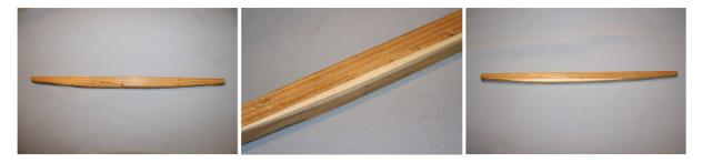
Ultimate le operazioni di recupero delle catene si procede quindi a prepararle all'incollatura: le parti di contatto vengono spianate cercando di perdere meno materiale possibile ed entrambe le catene vengono ridotte in lunghezza per evitare che tornino a premere sulla fasce rompendole. Una volta incollate le catene originali si procede a preparare la catena mancante di cui si possono scorgere i segni di incollatura che
